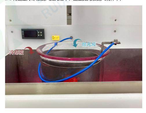
1.2 将循环泵电源、循环及制冷打开,注意控制进出流量以避免抛光槽内冷却液溢出。
