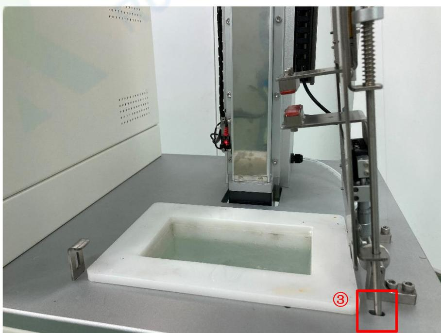
1.2 加水完毕后打开水模块的主电源开关 (即开关①), 再打开两个摇臂开关 (即开关②), 可通过温控器③的上下按键调节温度, PV 为当前温度, SV 为设定温度, 通常 SV 为 37°C;
