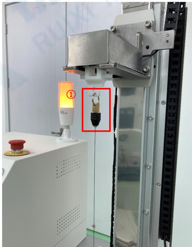
2.2 将砝码悬挂至挂绳上，砝码重量=设定的夹合力，且保证两边的砝码重量一致，即  $\text{单边砝码重量} = \frac{\text{设定的夹合力}}{2}$  ；
