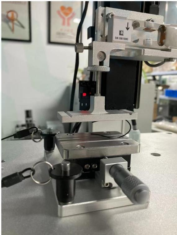
3.2.3 将测试产品对准上下平板凹槽放置于合适位置，可通过“上行”“下行”按键调整至所需的测试弯曲度。
