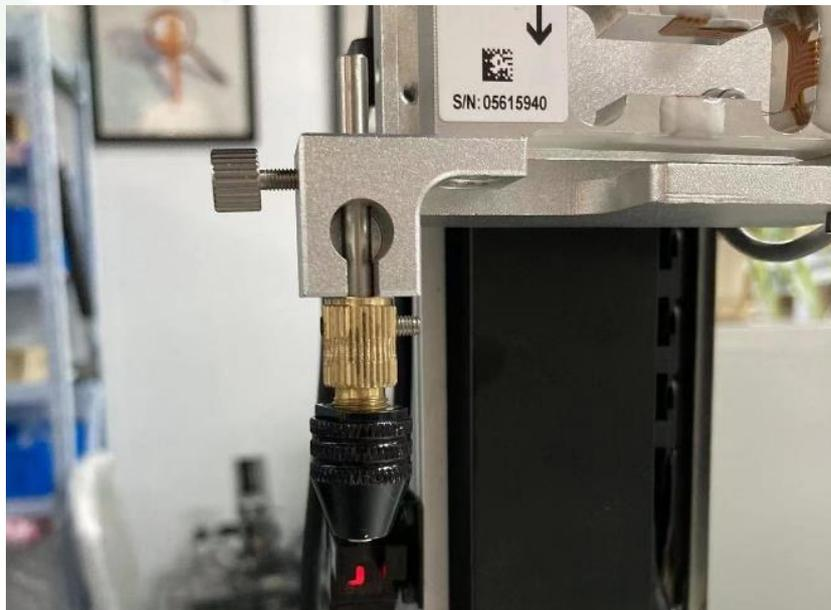
1.2.2 测试产品穿过夹具后锁紧三爪夹头。确认测试产品是否符合以下条件，如不符合上述条件，请进行重新调整，否则将影响测试结果。
