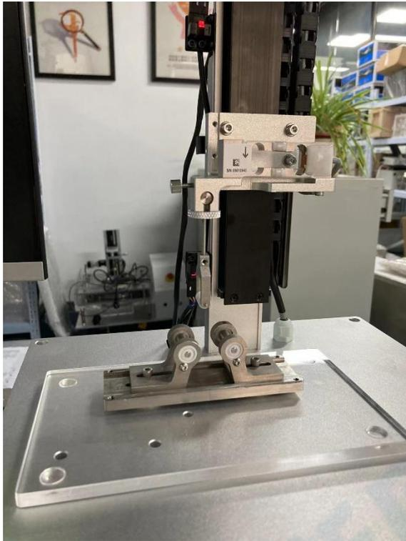
2.2.2 将下方固定支撑部件固定在操作台上，先将亚克力板对准操作台孔位，四点突起面朝下，两点凹面朝上，凹点朝向测试仪方向，再将金属部件对准空位固定在亚克力板上即完成工装的加装。
