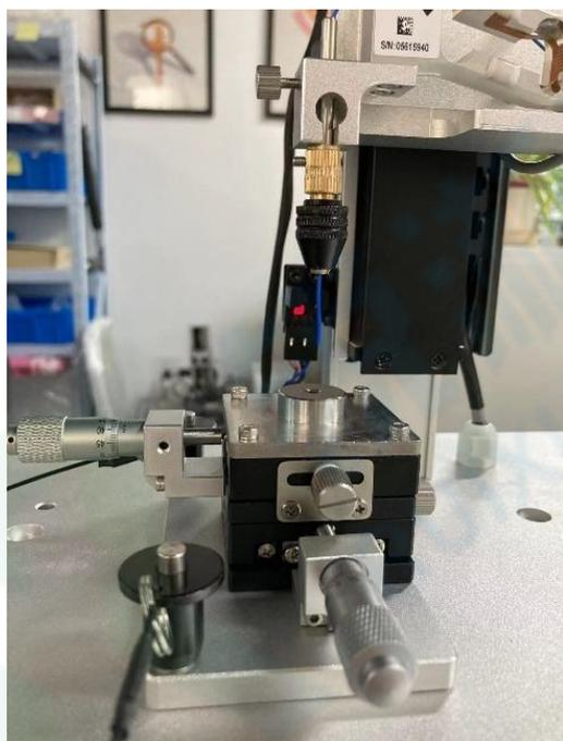
1.2.3 将微调平台置于夹具下方，用快拆销进行固定（快拆销需按下中心按钮后插入孔洞），通过扭动平台侧边微分头来进行位置调节，使产品对准平台中心圆孔。
