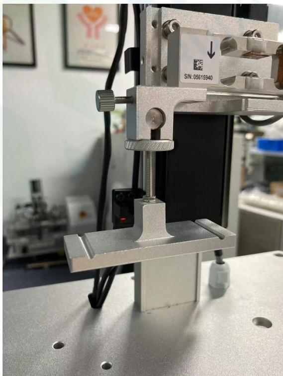
3.2.1 将上部 kink 工装加装在测试仪上，通过锁紧滚花螺母固定部件。
